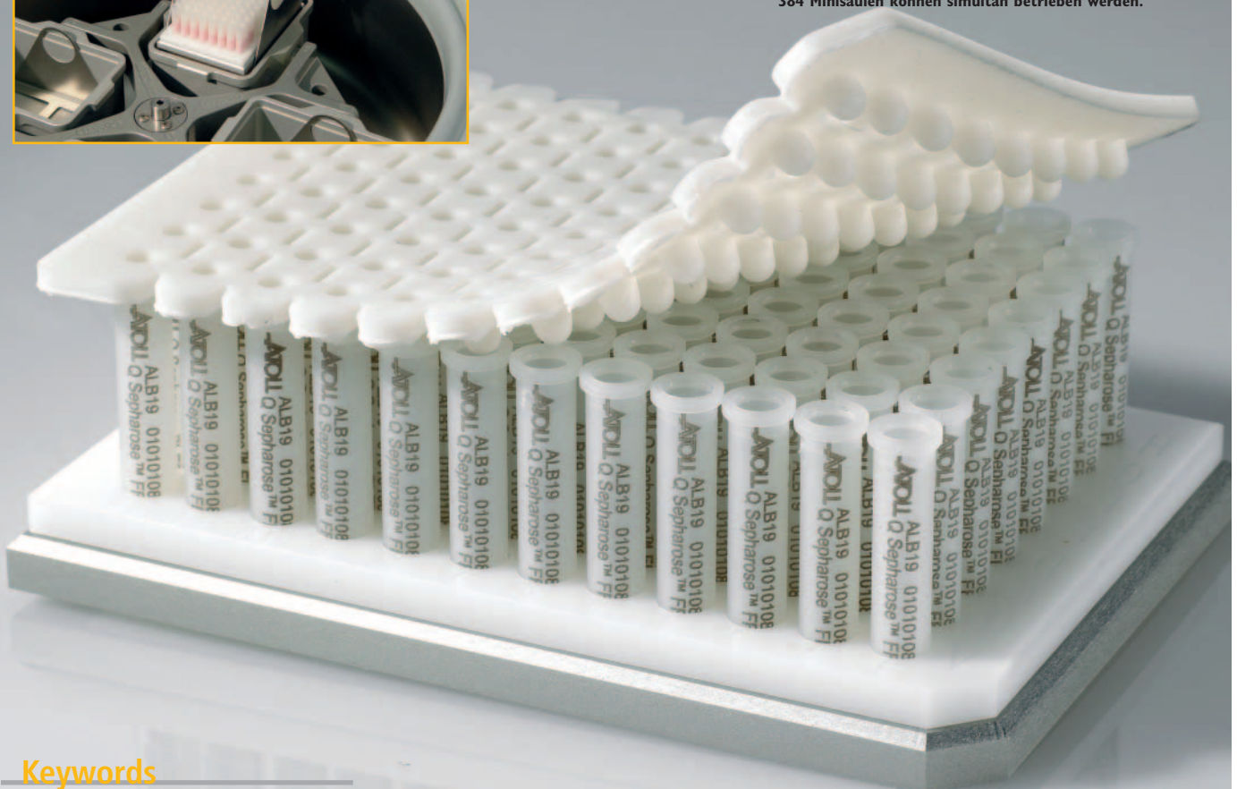
Abb. 1: a) Mit definiert gepackten Minisäulen bestückte mediascout Minisäuleneinheit im 96er Mikroplattenformat, mit partiell abgenommener oberer Verschlussmatte; b) Einsetzen einer Minisäuleneinheit in den Ausschwingrotor einer Laborzentrifuge. Zwei oder vier Einheiten mit insgesamt bis zu 384 Minisäulen können simultan betrieben werden.
